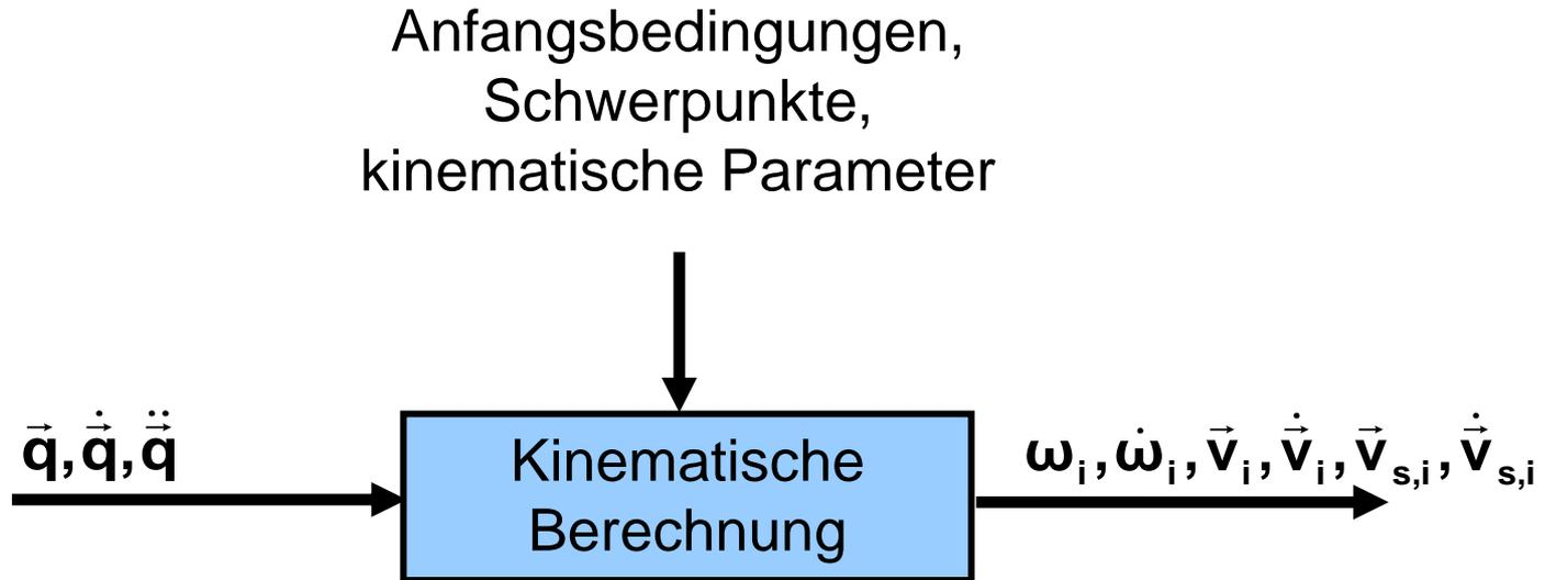
Die Geschwindigkeiten und Beschleunigungen für Armelement  $i+1$  lassen sich **rekursiv** unter Berücksichtigung der Kinematik aus den Geschwindigkeiten und Beschleunigungen des Armelementes  $i$  berechnen.
