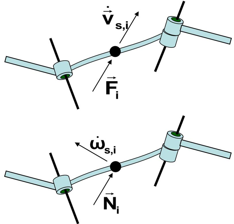
➔ Kräfte und Momente die auf ein Armelement wirken lassen sich aus Geschwindigkeit und Gelenkwinkelgeschwindigkeit berechnen.
